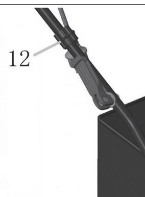
5. Vložte kovový rám ⑩ do látkového sběrného koše ⑨ a připevněte všechny příchytky na levou, pravou a zadní tyč rámu. Ujistěte se, že jsou všechny příchytky správně zajištěné (obr. 6).
