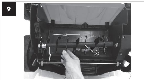
3. Nasuňte druhý válec na hnací hřídel tak, aby čep ⑤ zapadl do odpovídající části v hnacím hřideli ④ (obr. 10).
